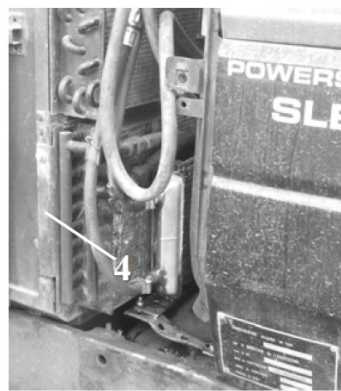
2 pav. Įranga degalų matavimui: 1 – degalų matavimo skaitiklis; 2 – filtras; 3 – oro separatorius; 4 – degalų aušinimo radiatorius.
