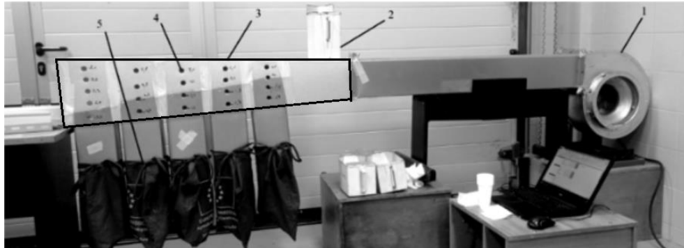
1 pav. Tyrimų stendas: 1 – ventiliatorius; 2 – sėkladėžė; 3 – grūdų rūšiavimo kamera; 4 – oro srauto greičio matavimo anga; 5 – maišelis
