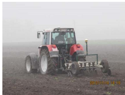
Fig. 18. Veris-3100 device upgraded with antenna holder frame 18 pav. Veris-3100 prietaisas patobulintas antenos laikiklio rėmu
