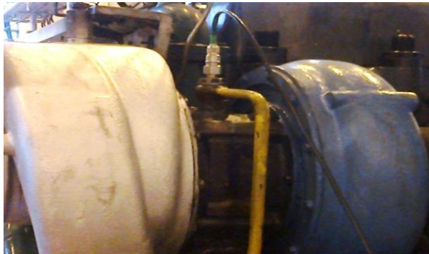
Fig. 3. Napier C-045/C type turbocharger with vibration sensor mounted on the bearing housing 3 pav. Napier C-045/C tipo turbokompresorius su ant guolio korpuso sumontuotu vibracijos jutikliu
