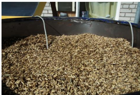
Fig. 3. Humidity measurement in grain layer 3 pav. Grūdų masės drėgmės matavimas
