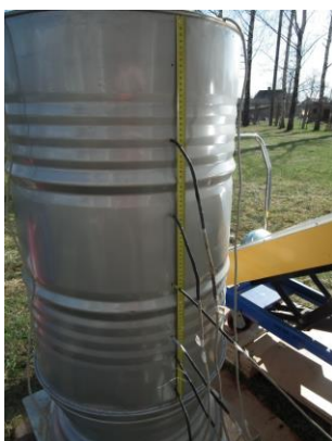
Fig. 2. Grain temperature measurement sensor location 2 pav. Grūdų temperatūros matavimo jutiklių išdėstymas
