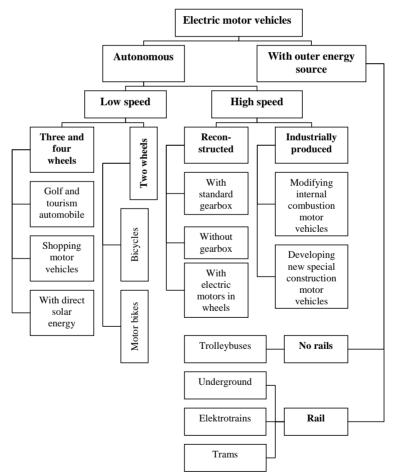
**Fig. 1.** Electric motor vehicle classification **1 pav.** Elektros variklių klasifikacija
