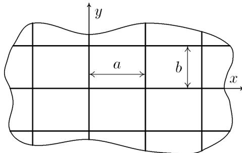
**Рис. 1.** Двоякопериодическая шарнирно закрепленная пластина
