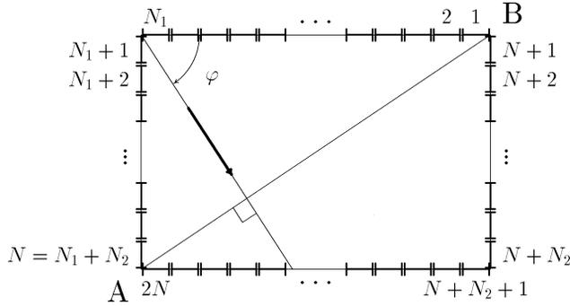
**Рис. 2.** Схема разбития границы периода пластины на граничные элементы
